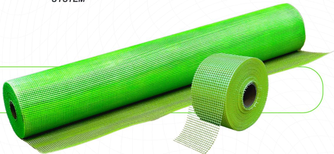
Tela e fita de junta em fibra de vidro com resistência alcalina, utilizadas no tratamento de juntas e estruturação da superfície sobre as chapas cimentícias ProFort Next, evitando o surgimento de trincas e fissuras, sendo aplicada juntamente com a massa Base Coat.
