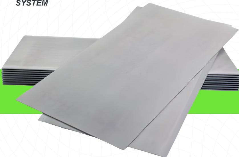
As Placas Cimentícias CimenPlac são fabricadas com a tecnologia CRFS (Cimento Reforçado com Fios Sintéticos) para sistemas construtivos à seco. São produzidas a partir de uma mistura homogênea de cimento Portland, agregados naturais, fibras de celulose e fios sintéticos de polipropileno. Recebem ainda tratamento adicional de impermeabilização na massa, que confere maior estabilidade dimensional além de reduzir a permeabilidade.
