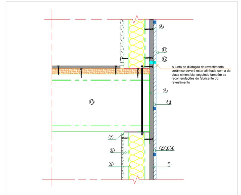
A junta de dilatação do revestimento cerâmico deverá estar alinhada com a da placa cimentícia, seguindo também as recomendações do fabricante do revestimento
